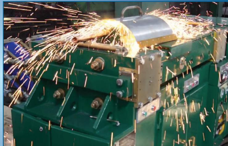
Машина МСО-604 предназначена для сварки непрерывным оплавлением и оплавлением с предварительным подогревом труб и других изделий, преимущественно круглого сечения, из перлитных, аустенитных, высоко и низкоуглеродистых, различных легированных сталей сечением до 850 мм<sup>2</sup> и наружным диаметром до 42 мм.
